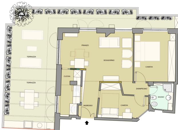
Planimetria dell'immobile dopo la ristrutturazione del 2008
